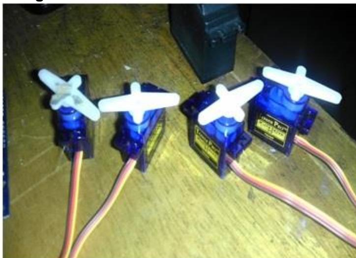
**Fotografía 5.6 servomotores tower pro sg90**
