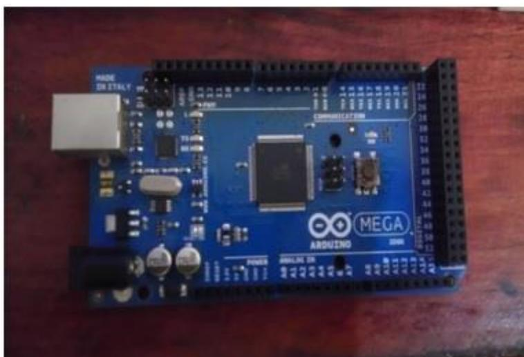
**Fotografía 5.9 tarjeta arduino mega**
