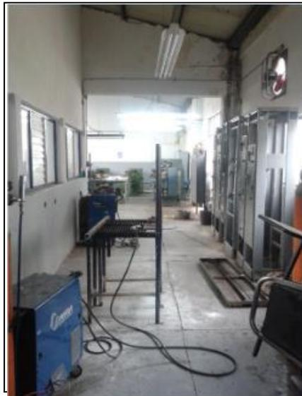
Este espacio cuenta con medidas totales de 3,400 mm x 7,100mm, donde se tendrá que disponer la localización de una máquina soldadora de plasma, una máquina soldadora de micro alambre y 3 máquinas de arco eléctrico, adicionalmente se dejará espacio para los bancos soporte de trabajo de las piezas a soldar.
